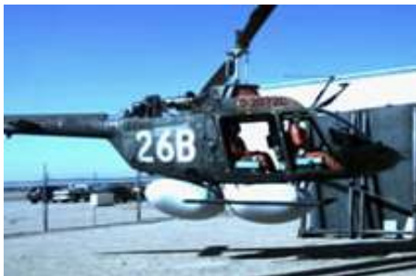
Zastosowanie zewnętrznej poduszki w helikopterze wojskowym (Rafael).
