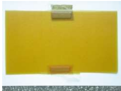
Fot. Płytki kompozytowe szklano-epoksydowe z wbudowanymi elementami PZT
